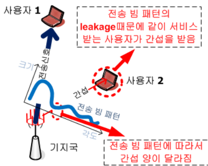
그림 2. 방향성 전송에서의 간섭문제 Fig. 2 Interference in Directional Transmission
